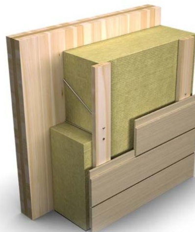
Fig. 1 Prinsipiell utførelse av PAROC ZEROfix montert på eksisterende veggkonstruksjon. Eksempel med utvendig trekledning. Figur: Paroc AB
