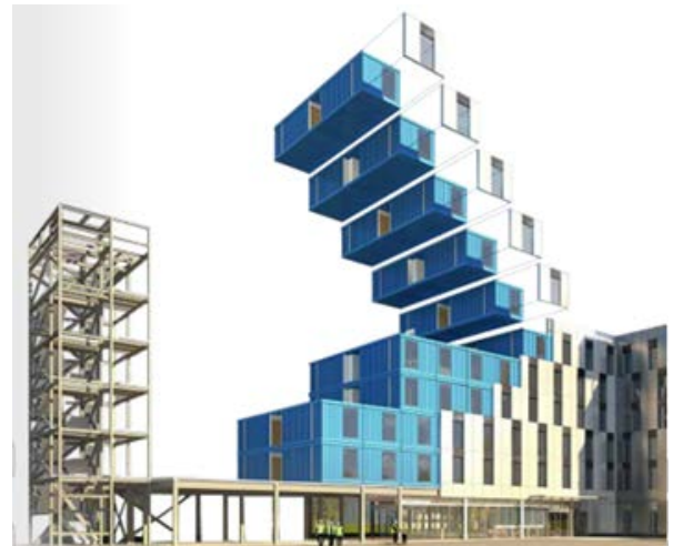
Fig.1 Prinsipp for sammenbygging av moduler til hotellbygg
