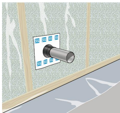
Fig. 5 Icopal Ventex Rørmansjett Vegg benyttes til tetting av rørgjennomføringer i damp- og vindsperresjiktet.
