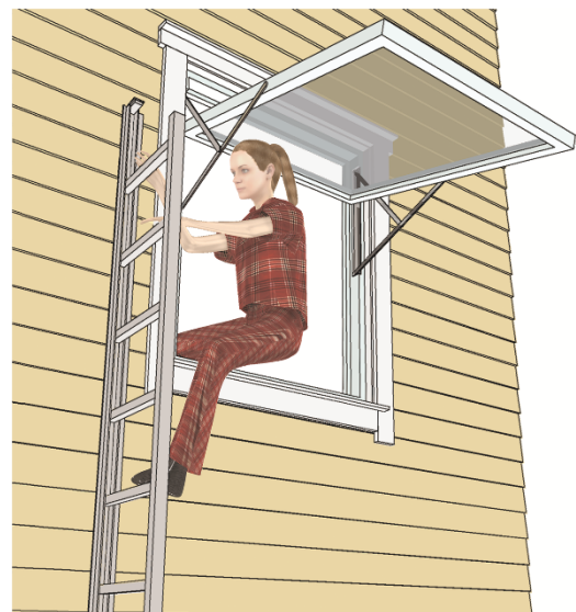
Fig. 1 Norstigen i bruk under rømning
