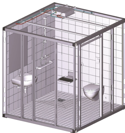
Bathsystem Superlight Bathroom Pod. Inne og installasjoner
