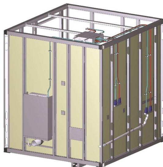
Fig. 2 Bathsystem Superlight Bathroom Pod. Utside og installasjoner
