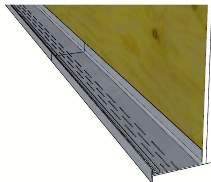
Fig. 5: Glava AS Glava Driv startlist festet til bakenforliggende veggkonstruksjon.
