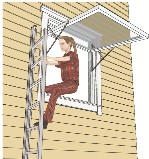
Fig. 1 Sørlandsstigen i bruk under rømning
