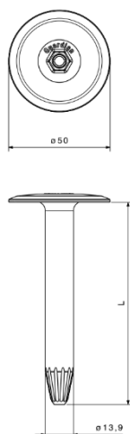
Fig. 5 ASTL50 festebrikke / hylse Hylse lik RP50n, tilpasset for bruk med skrue ACS-6,1
