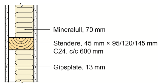
Fig. 2 Prinsipiell oppbygning av ikke-bærende innervegger
