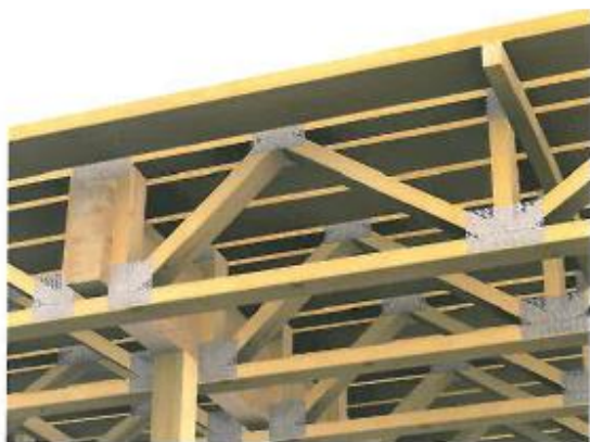
Fig 6 Gitterbjelkelag med tverrgående bærebjelke understøttet av søyle
