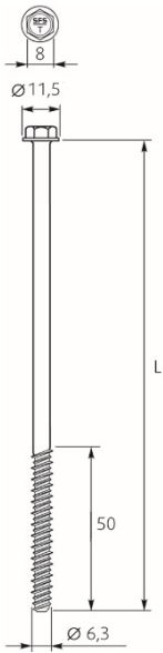
Fig.23 SFS TI 6,3 Screw for concrete
