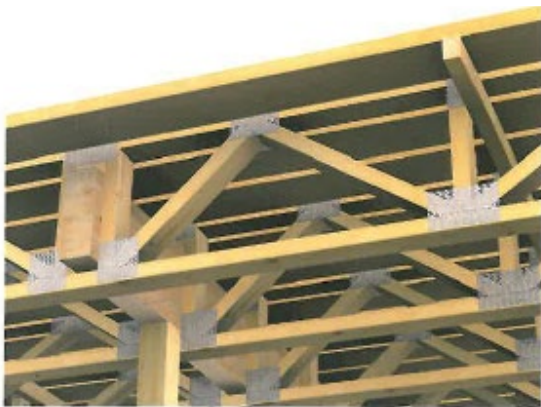
Fig 6 Gitterbjelkelag med tverrgående bærebjelke understøttet av søyle
