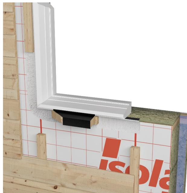
Fig. 9 Tetting rundt vinduer på utsiden av vindsperran ved bruk av Isola FlexTett 100 Vindus Rims. Figur: Isola as
